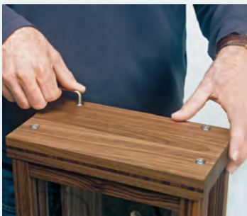
Einfache Montage der Gehäuseteile mit Inbusschrauben
