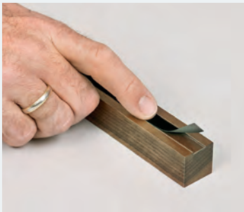
Anbringen der Türdichtung zum Schutz vor eindringendem Staub
