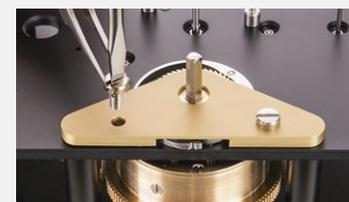
Vorder- und Hinterplatine erst noch der Sperrradkloben\* und das Gesperr\* entfernt werden müssen. Das Gesperr darf jedoch nur bei entspanntem Federhaus zerlegt und entfernt werden.
