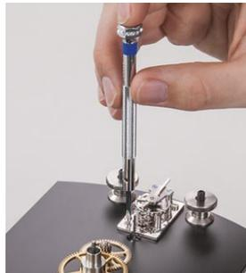
Das Echappement wird nun vorsichtig mit zwei Zylinderkopfschrauben M2 x 4 auf der Vorderplatine verschraubt. Damit das Echappement seine Funktion einwandfrei erfüllen kann, muss es unbedingt plan auf der Vorderplatine aufliegen und fest verschraubt sein.
