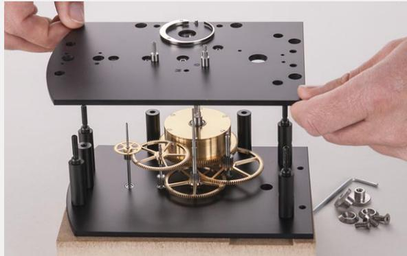
Die drei Sicherungspfeiler werden mit M4 x 10 Senkkopfschrauben verschraubt. Diese Verschraubung ist sehr wichtig um dem unbeabsichtigten Öffnen des Uhrwerks vorzubeugen!
