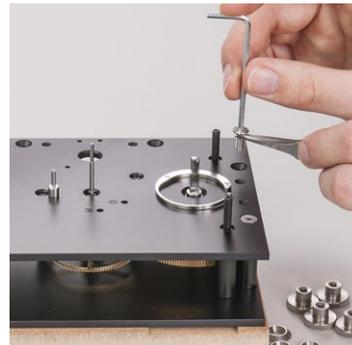
Die drei Sicherungspfeiler werden mit M4 x 10 Senkkopfschrauben verschraubt. Diese Verschraubung ist sehr wichtig um dem unbeabsichtigten Öffnen des Uhrwerks vorzubeugen!
