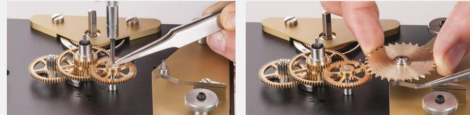
Bitte beachten Sie beim Aufsetzen des Datumsrades, dass der Schaltstift des Schaltrades frei liegt und nicht durch das Datumsrad geklemmt wird.
