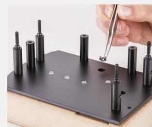
Eine weitere Änderung zum Standard-Uhrwerk ist auch die Positionierung des großen Federhaus-Kugellagers. Dieses wird ebenso wie die Sicherungspfeiler in die Kugellagerplatte an der rechten Seite der Hinterplatine eingesetzt. Auch hier bleibt demzufolge die unterste Kugellagertasche der Hinterplatine leer.
