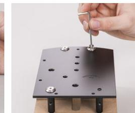
Setzen Sie die vier Werkpfeiler in die Bohrungen des Montagesockels. Dann wird die Platine\* auf den Ansätzen der Werkpfeiler platziert. Dabei zeigt die Gravur »Mechanica W5« auf der Rückseite der Hinterplatine nach oben. Die unterschiedliche Form der Pfeileransätze verhindert Verwechslungen. Legen Sie die vier Beilagscheiben auf und verschrauben Sie die Pfeiler\* mit den vier Inbus-Senkkopfschrauben M4x10. Wenden Sie die Platine und schrauben Sie nun die drei Sicherungspfeiler mit der Hand ein.
