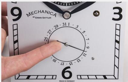
Das richtige Datum wird durch Verdrehen des Datumszeigers eingestellt. Beachten Sie aber unbedingt dass während des Schaltvorgangs das Datum nicht verstellt werden darf. Sollten Sie einen Widerstand spüren drehen Sie nicht mit erhöhter Kraft weiter, es könnten sonst diverse Teile des Uhrwerks beschädigt werden!
