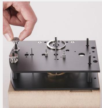
Um Klemmungen in den Lagerstellen auszuschließen, prüfen Sie nach dem Verschrauben der Platinen\* das Höhenspiel der Wellen\*. Fassen Sie dazu die Wellen vorsichtig mit der Pinzette und führen eine Bewegung in Achsrichtung aus. Wenn Sie das Werk umdrehen, müssen die Wellen hörbar gegen die dem Boden zugewandten Lagerstellen fallen.
