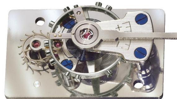
Zum Einsetzen des Echappements fassen Sie dieses am besten nur an der Grundplatine oder am Unruhkloben an.
