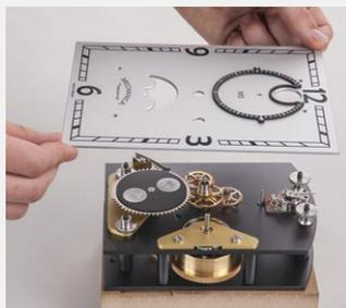
Das vormontierte Zifferblatt wird vorsichtig auf die vier Rändelmuttern der Werkpfeiler\* aufgesetzt und mit vier Zylinderkopfschrauben M2 x 4 befestigt.
