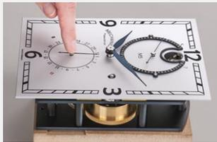
Der Datumszeiger wird in das Rohr des Datumsrades geschoben. Achten Sie hier darauf dass der Zeiger schon möglichst genau auf eine Ziffer des Datums zeigt. So ersparen Sie sich später das aufwändige Ausrichten des Zeigers.
