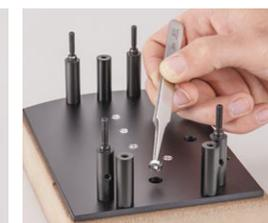
Setzen Sie danach die fünf Edelstahl-Kugellager in die werkseitigen Taschenfräsungen der Hinterplatine ein. Wegen der unterschiedlichen Durchmesser passen die Lager nur an der richtigen Stelle. Auf welcher Seite sich dabei der Rollenkäfig der Kugellager befindet ist nicht von Bedeutung.
