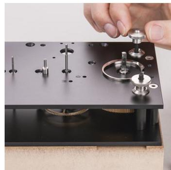
Um Klemmungen in den Lagerstellen auszuschließen, prüfen Sie nach dem Verschrauben der Platinen\* das Höhenspiel der Wellen\*. Fassen Sie dazu die Wellen vorsichtig mit der Pinzette und führen eine Bewegung in Achsrichtung aus. Wenn Sie das Werk umdrehen, müssen die Wellen hörbar gegen die dem Boden zugewandten Lagerstellen fallen.
