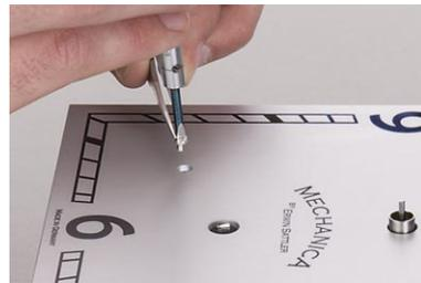
Das vormontierte Zifferblatt wird vorsichtig auf die vier Rändelmuttern der Werkpfeiler\* aufgesetzt und mit vier Zylinderkopfschrauben M2 x 4 befestigt.
